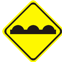
A - 17 PISTA IRREGULAR
