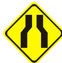
A - 21a ESTREITAMENTO DE PISTA AO CENTRO
